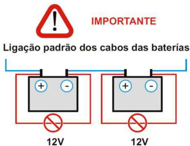
Figura: ¡IMPORTANTE! Conexión de cable de batería estándar.
