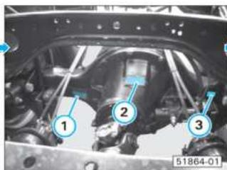
PASSO 4: VERIFICAR SE A RELAÇÃO NA PLAQUETA DA CABINE EQUIVALE A RELAÇÃO NA PLAQUETA DO EIXO
