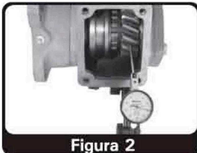
2. Gire ligeramente el engranaje hasta encontrar resistencia al movimiento (fig. 2). La aguja del reloj debe marcar la holgura (backlash) encontrada, que debe estar entre 0,15 mm y 0,30 mm.
