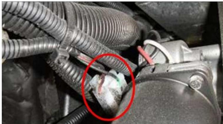
Foto 3 – conexiones no estancas en la región externa
