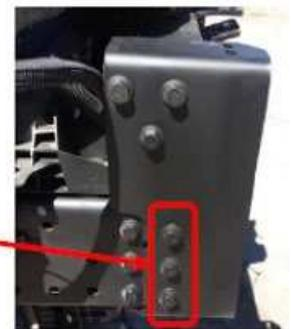
Vista lateral esquerda do rebocador, com o detalhe dos 3 pontos (M12x1,5 – Torque: 100 ± 10Nm) de fixação na longarina
