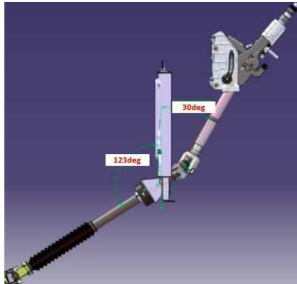
Vista lateral con telescopio del árbol de la columna de dirección y ajuste angular en la condición inferior.
